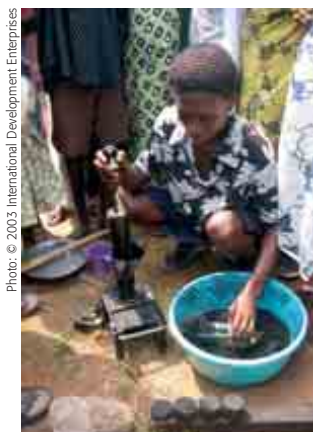
Femme sur le marché de Jukwa au Ghana fabriquant des briquettes haute densité à l'aide d'une presse conçue et fabriquée par le D-Lab du MIT.
