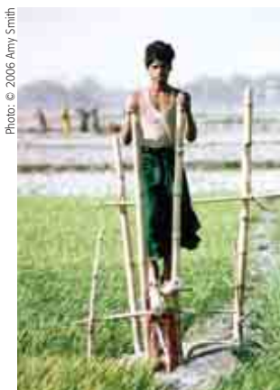
La pompe à pédale en bambou conçue par Gunnar Barnes et International Development Enterprises Nepal est fabriquée dans des ateliers locaux au Népal et au Bangladesh.
