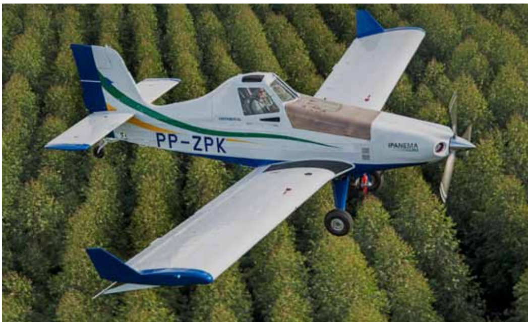
L'Ipanema d'Embraer est le seul avion au monde à fonctionner exclusivement à l'éthanol.
