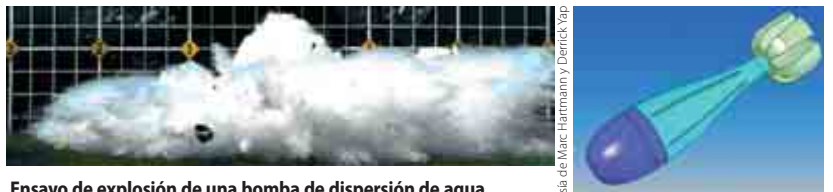
Ensayo de explosión de una bomba de dispersión de agua.
