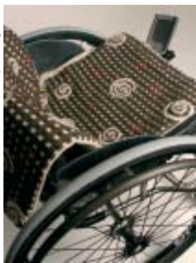
Tejido con fibras conductoras, la tela puede incorporar elementos térmicos o sensores electrónicos con una miríada de usos.
