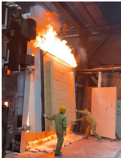
CLT ログハウスの外壁耐火性能試験の様子
