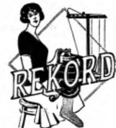
Machines rondes à tricoter à manivelle avec un support de bobines et une soupape d'arrêt pour faire les pointes et les talons de bas.
