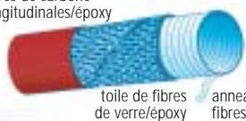
Coupe transversale d'une perche moderne
