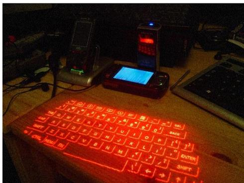
Рис. 1. Лазерная клавиатура<sup>1</sup>
