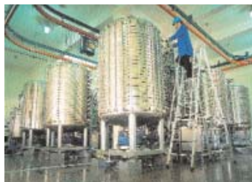
Le PlaFactor, ou l'invention d'un nouveau système de fermentation, est la grande découverte technique et commerciale de Biocon.
